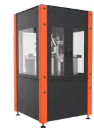
Stand-alone dos cell Achssystem inklusive Schutzzone für Bewegung des Dosierers in 3 Freiheitsgraden.
