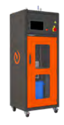
Materialversorgung ab 70.000 mPa·s dos feed H Fördern von abrasiven und nicht-abrasiven Materialien aus Hobbocks ab einer Viskosität von 70.000 mPa·s.
