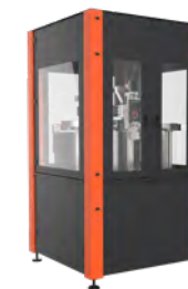
Stand-alone dos cell Achssystem inklusive Schutzzone für Bewegung des Dosierers in 3 Freiheitsgraden.
